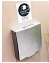
「復興號」車廂內設置了不斷斷供電的旅客用220伏電源插座。網上圖片
