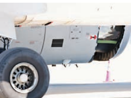
東方航空MU736航班左側引擎內側的整流罩穿了一個大洞。
