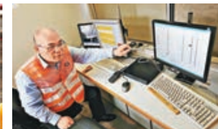
軌檢車上儀器可查驗架空電纜與軌道是否正常。
