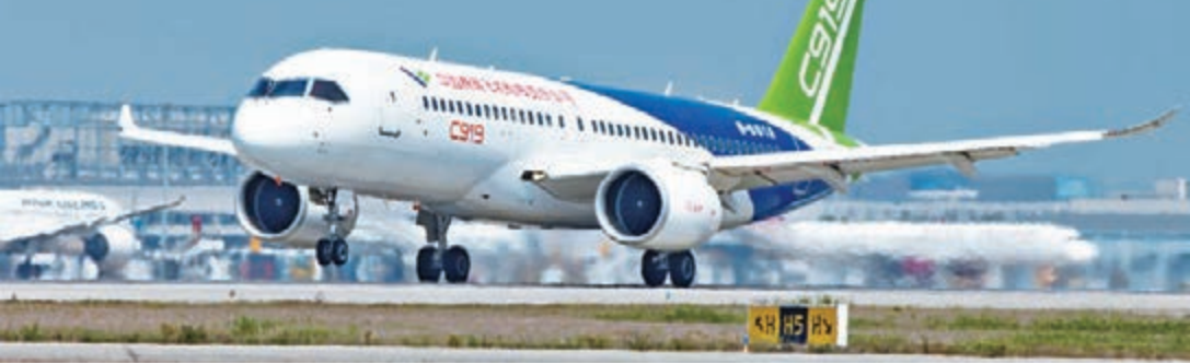
■C919大型客機昨日在上海浦東機場進行高滑抬前輪試驗，取得成功。
