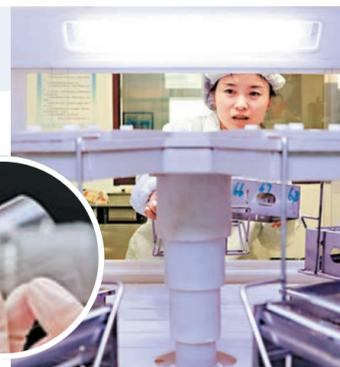
應用在天舟一號上的高強度柔性抗輻照玻璃蓋片，是由秦皇島星箭特種玻璃有限公司歷時一年時間研製成功的產品。這種玻璃蓋片在能保證抗輻照能力和高透光率的前提下，不僅要做到超薄，還要增加柔韌性和抗彎強度，避免運行時玻璃蓋片碎裂。新華社
