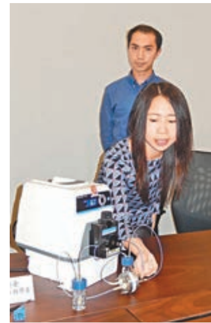
■盧怡君指，電池設有可替換儲罐（藍蓋瓶子）。 姜嘉軒 攝
