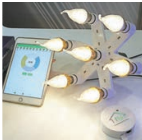
■無線燈利用專利技術，只要在枱底貼上電力板，電力板便可通過任何非金屬材料傳輸電力至枱上的枱燈，安裝簡單，避免礙眼的電線。 香港姆歐尼
