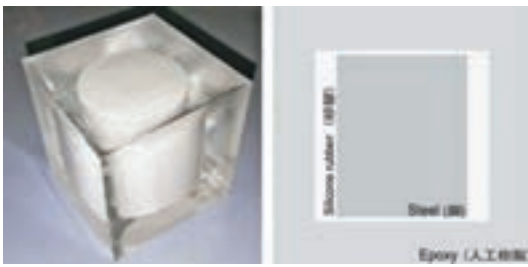
■超材料由鋼柱、矽膠和人工樹脂的3種固體物料組成。科大供圖
