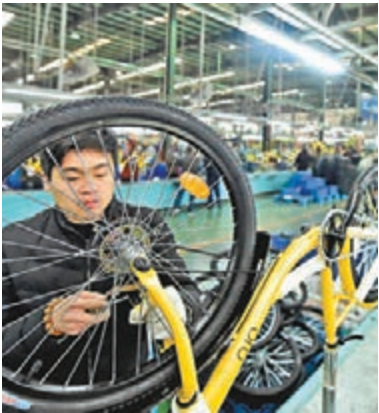
■天津「飛鵲」車廠與共享單車企業合作。圖為工人在車間內安裝ofo共享單車。 資料圖片
