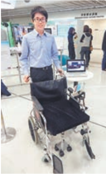
■林華盛和同學設計的自動變形輪椅，可透過手機應用程式及微型電腦控制輪椅升降及座位移動。黎志攝 ■陳百均則與同學研發出復康機械手，為因意外折斷手臂或中風人士使用。黎志攝
