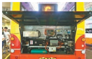
■一個摩打配合波箱推動,上斜更有力。
