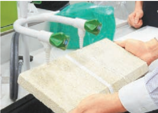
圖為汪遠昊示範，塗抹了防塵塗料的版（右邊），水珠隨即流下，但未有塗抹的部分（左邊）就吸收了水分。黎恣攝
