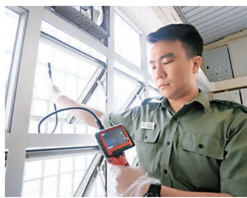
懲教署人員使用手持式視頻伸縮安檢儀,及便攜式安檢內窺攝錄儀進行搜查。
