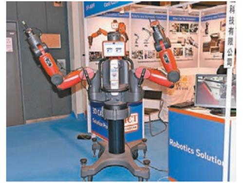
春電展展出全球首個雙臂操作、可在生產線上工作的智能機械人,能通過特定指令培訓處理不同工序。
