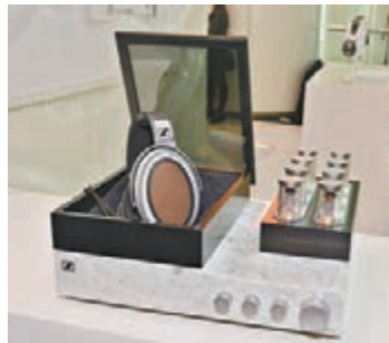
HE1 啓動後，連帶右邊由石英玻璃管覆蓋的真空管亦隨之升起。
