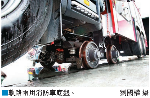
■軌路兩用消防車底盤。劉國權攝 ■兩側配備電動水霧風扇。劉國權攝
