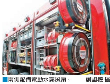
■軌路兩用消防車底盤。劉國權攝 ■兩側配備電動水霧風扇。劉國權攝
