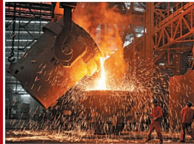
■內地工業持續發展。圖為工人在東北特鋼集團大連基地煉鋼區域觀察鋼水倒渣情況。 資料圖片
