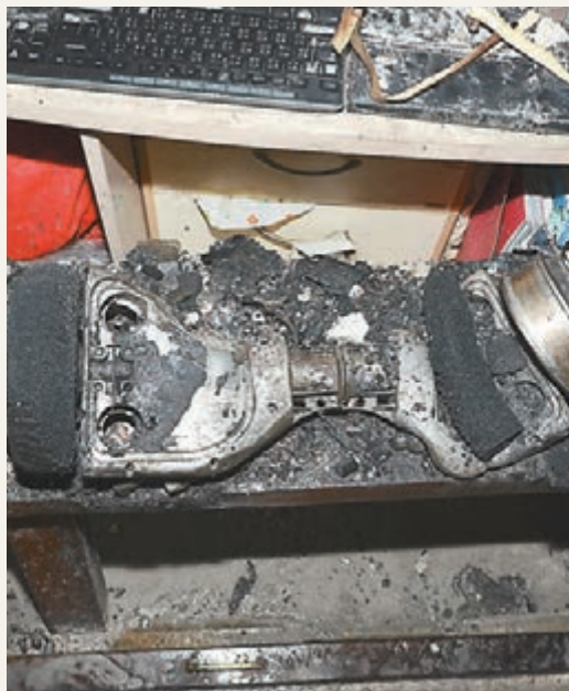
▲充電期間懷疑短路起火及傳出爆炸聲響的兩輪電動踏板車。
