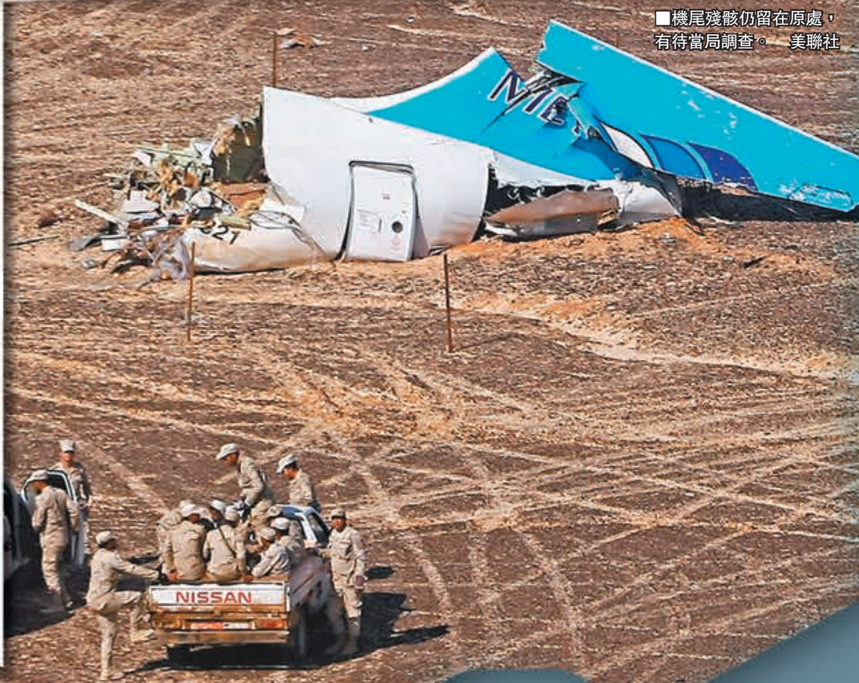
機殼斷開部分外彎，意味令客機解體的力量由機內向外爆發，可能由炸彈引致。
