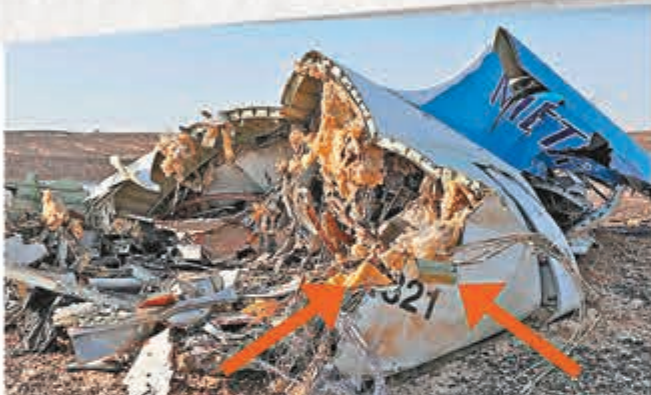
機殼斷開部分外彎，意味令客機解體的力量由機內向外爆發，可能由炸彈引致。
