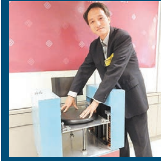
鄭家偉(右)和團隊研發的「超級電容板」,只需3分鐘至5分鐘就可完成充電,供電動車行走30公里。電容板可望在明年年底推出市場。記者黎志攝
