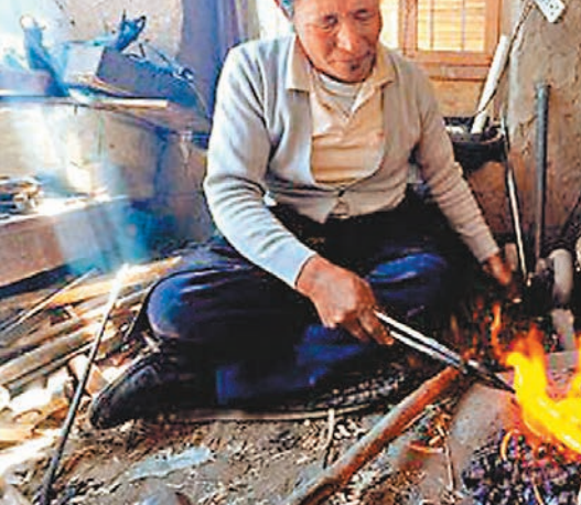
■普達瓦坐在工作坊裡，點燃木炭堆上的一把乾草，搖動鼓風機，爐子很快火焰騰騰。網上圖片
