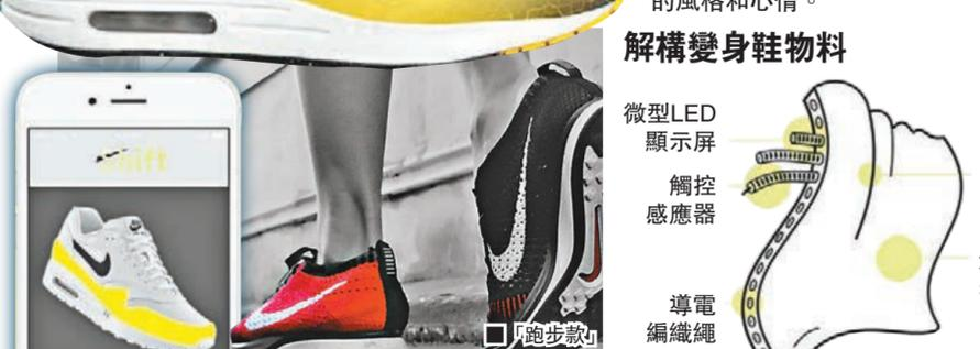
這種新概念的「變身運動鞋」(Shift Sneakers)，由+rehabstudio的英國設計團隊構思，融合高科技纖維、導電編織繩及先進紡織品製成，用手觸摸鞋蹣表面的敏感薄膜，即可發出電流脈衝，促使相應纖維改變形狀，改變反光物料的位置及排列，令運動鞋呈現不同顏色。
