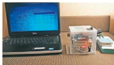
雲端空氣質素及氣象監測系統(PAWMS-C)的實物照片。
