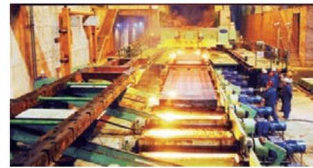
■國內自主研發建設的世界首台420mm直弧型厚板坯連續鑄機在新鋼集團問世。
