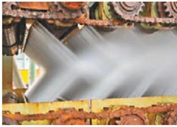
遼寧研發輓式淬火機，實現國內「零」突破。圖為噴咀優化組合測試。網上圖片
