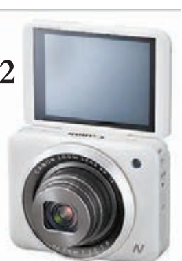
配合可上揭180度的2.8吋多角度電容觸控式LCD螢幕，方便自拍。
