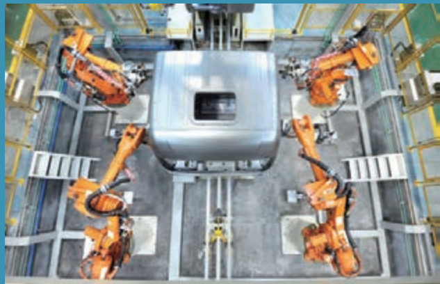
■徐工重卡車身的衝壓、焊接採用國內外成熟工藝與高效節能的製造設備保證質量。
