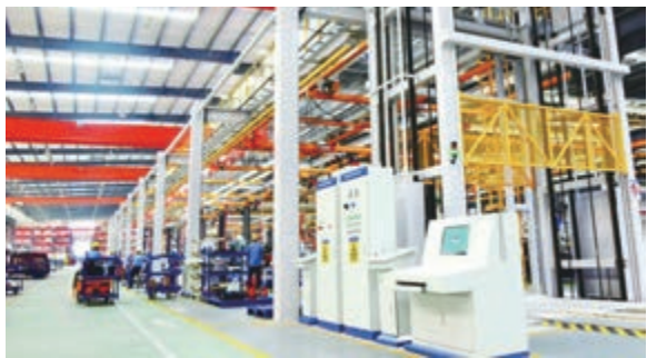
■環境產業公司混合裝配流水線正式運行，這是目前國內唯一一條以RGV流水線方式作業的環衛車裝配線。
