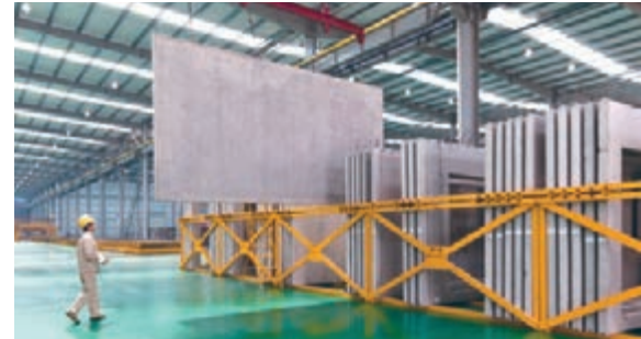
■ 遠大住工長沙麓谷工廠內，等待裝運的預製混凝土構件。
