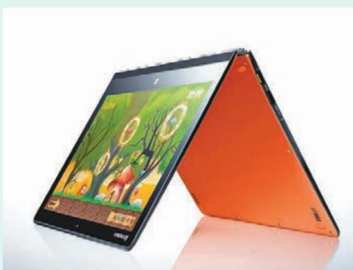
支援多達四種操作模式的 13 吋 Lenovo YOGA 3 Pro 筆記簿形電腦，以型格外形、頂級效能及兼容性極高的軟硬件配置吸引一眾高端用家。外形纖巧輕薄的 YOGA 3 Pro 機身只有 12.8 mm、僅重 1.19kg。除採用 Intel Core M 5Y70 處理器及 QHD+ (3200 x 1800) 螢幕外，為了讓 YOGA 3 Pro 關節擁有如手錶錶鏈般的靈活性，Lenovo 特別研發由鋼鐵及鋁材製成的 Watchband 關節，並設有 6 個可動部分，突破一般筆記簿形電腦關節只設 2 個可動部分的傳統，大大提升產品的靈活性。
