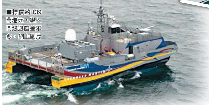
■Sea SLICE 採用四體船設計，穩定性優越。網上圖片
