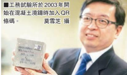
■工務試驗所於2003年開始在混凝土澆鑄時加入QR條碼。 莫雪芝攝
