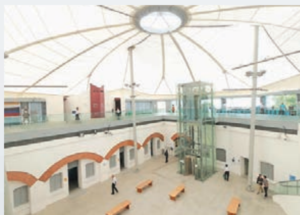
■博物館室內採用天然採光，並減少支柱，免影響古炮台建築結構。
