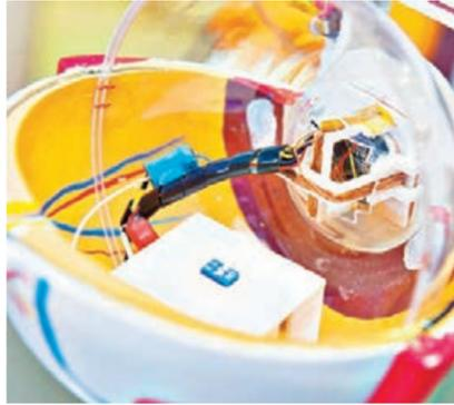
■城大設計的「電子眼」接收線圈以多維結構作基礎,並結合多維電能匹配技術作整體電力傳輸。城大供圖
