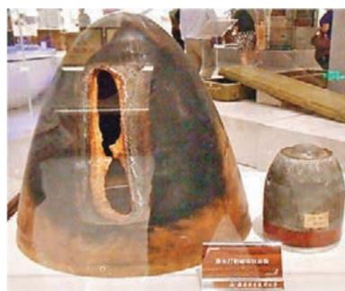
■中國激光武器研究已有一定的基礎。圖為在試驗中被激光武器命中的目標。網上圖片
