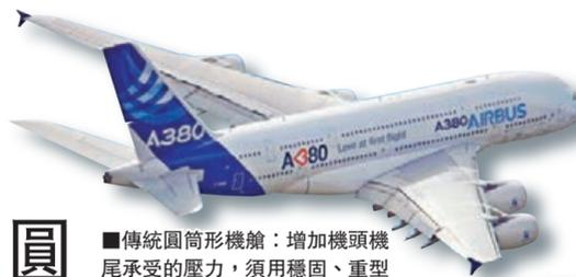
傳統圓筒形機艙：增加機頭機尾承受的壓力，須用穩固、重型結構支撐，限制了載客空間。
