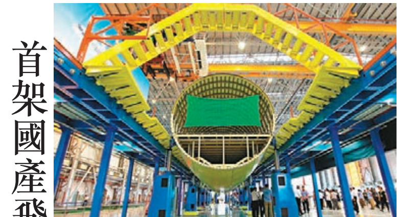
裝配線上進行對接的C919首架機的機體。
