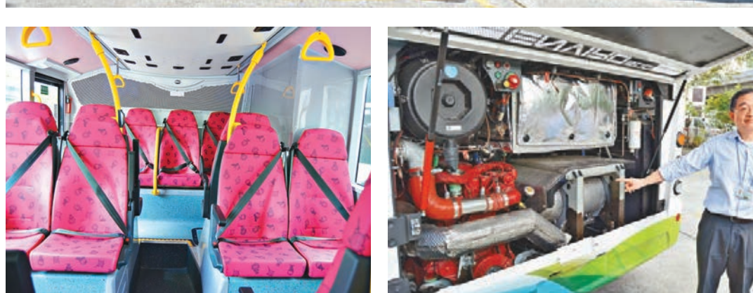
「hBus」車尾需設置電池，座位較同長度巴士少。蘇慶順表示，「hBus」慢速行駛時可單靠電力驅動，預計可節省耗油達30%。羅繼盛 攝
