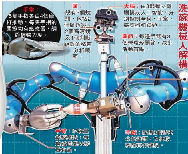
手掌：5隻手指各由4個摩打推動，每隻手指的關節均有感應器，調節握物力度。
