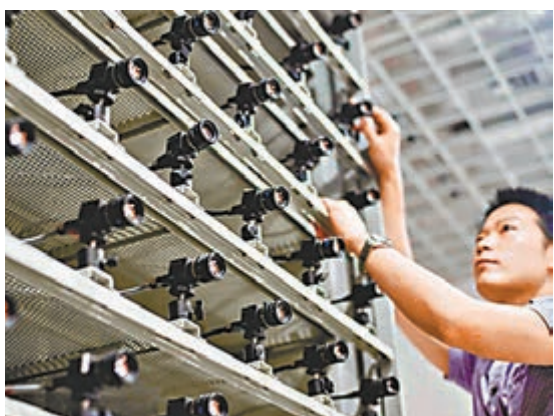
全天候移動式同步人臉採集陣列能夠從91個角度對人臉同步採集。
