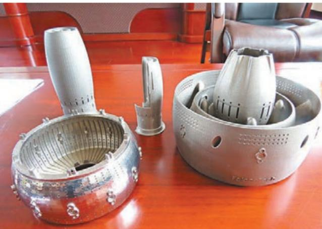
飛而康用3D金屬打印技術製造出的航空配件。
