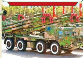
PHL-03型300毫米多管火箭武器系統的一個基本作戰單元包括1輛指揮車、4至6輛發射車和4至6輛運彈車。每輛發射車可連續發射24發火箭彈，1個作戰單元可連續發射火箭彈96至144發，覆蓋大於2平方公里的範圍。PHL-03火箭採用固體燃料發動機推進，據稱，其最大射程達150公里，彈頭應該類似「龍捲風」火箭炮，採用帶有反裝甲/人員高爆炸子彈藥的集束彈頭。
