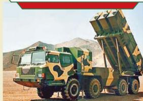
衛士-2火箭彈直徑406毫米，總重1285公斤，總長7302毫米。殺傷半徑在450米以上。最大飛行速度5.6馬赫。該火箭炮可配備高爆炸彈、燃燒彈、鑽地彈、子母彈等，攻擊精確度非常高，射程360公里。衛士-2還有一種火箭彈內可攜帶三個小型無人機。抵達目標上空後投放攜帶自殺彈藥的無人機，然後搜索地雷雷達信號，可在最大射程上進行反雷達作戰和電子干擾作戰。
