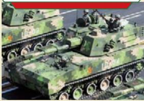
PLZ-07式是國產第3代122毫米自行榴彈炮。車長6.66米，寬3.28米，高2.5米，裝配一門122毫米PL-96榴彈炮，炮塔頂上有一挺12.7毫米機槍。榴彈炮戰鬥全重24.5噸。炮發射122毫米制式彈藥，可在高低0°-70°，方向左右各22.5°範圍內射擊。發射底凹彈時最大射程達18公里，發射底排彈最大射程為22公里，發射底排火箭增程彈的最大射程可達27公里。火炮最大射速6-8發/分鐘。
