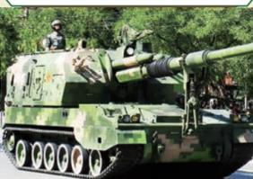
中國研製的主戰炮兵裝備之一，由PLZ45型自行加農榴彈炮發展而來。PLZ-05自行榴彈炮系統發射低阻全膛底排彈射程超過50公里，發射火箭增程底排彈的射程可達70公里。網上資料指，其載彈量為25發，最大射速8-10發/分鐘，配用彈種：底凹榴彈、底排榴彈、雙用途子母彈、未敏彈、激光制導炮彈、照明彈、發煙彈、黃磷燃燒彈，底凹榴彈45.5公斤，底排榴彈47.9公斤。
