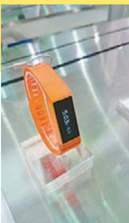
■錶身帶有一個單色的 OLED 屏幕，可以顯示日期、時間及天氣資訊。
