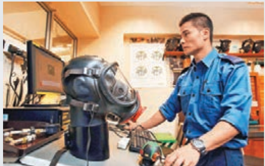
■現時設於每間消防局內的呼吸器室，為維護個人面罩及呼吸器，都透過自動電腦測試儀，確保呼吸器的功能運作良好。 劉國權 攝
