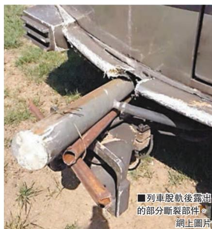
■列車脫軌後露出的部分斷裂部件。網上圖片
