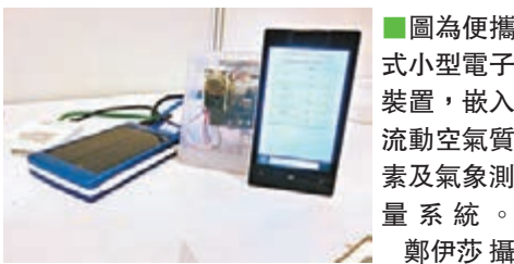
圖為便攜式小型電子裝置，嵌入流動空氣質素及氣象測量系統。鄭伊莎攝
