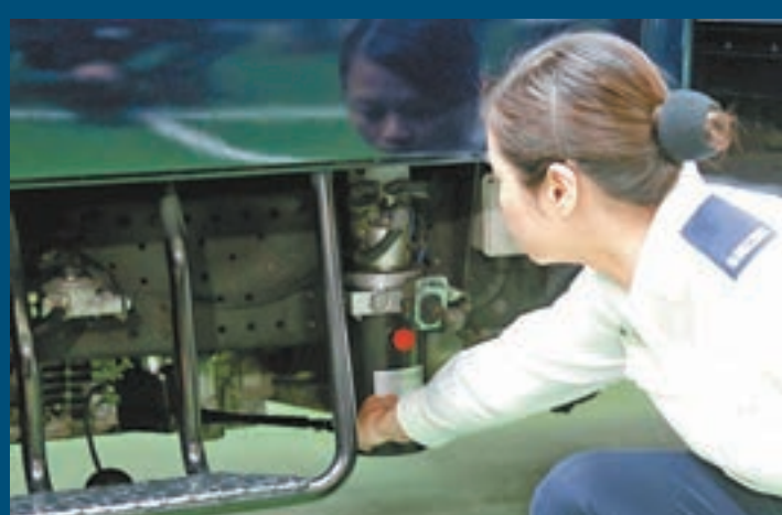
安裝在車底的感應器可偵察匿藏人士的心跳脈動。
