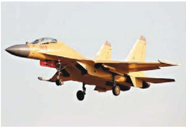
■殲-16取消了機頭空速管，雷達罩採用淺灰色塗裝。 網上圖片
