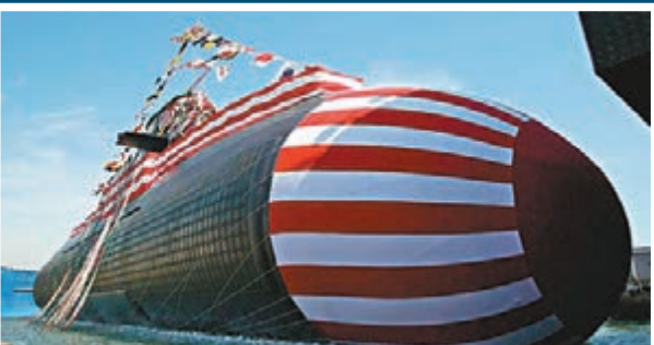
「親潮級」潛艇 11艘，現役潛艇主力，艦艏採用單殼、雙殼複合形式，利於在耐壓殼上安裝側舷聲納，實際聲納感知能力得到很大提高。火控系統升級，自動化水平進一步提升。
