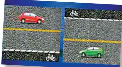
兩段橋面相接處，行車線和單車徑方向倒轉。網上圖片
